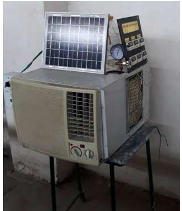
شكل (4) مكيفة الهواء موضح عليها ربط اجزاء منظومة الترطيب
