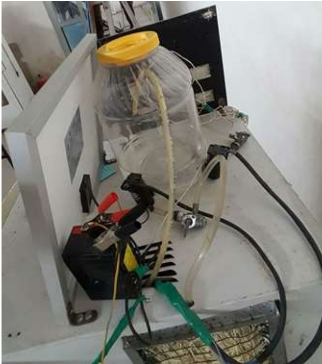
شكل (4) مكيفة الهواء موضح عليها ربط اجزاء منظومة الترطيب
